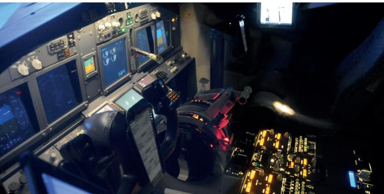
Speziell für die Aufgabenstellungen des Type-Ratings und der Multi-Crew-Coordination-Ausbildung werden Flight and Navigation Procedure Trainer (FNPT) genutzt.
