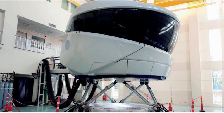
BRUNNER adressiert mit Ihren innovativen Control Loading Systemen und Einzelkomponenten für Flugsimulatoren das gesamte Spektrum moderner Flight Simulation Training Devices. Im High-End Bereich sind dieses Full-Flight-Simulatoren (FFS), die als typspezifische Full-Size-Replika alle physikalischen und operativen Merkmale des Original-Luftfahrzeuges abbilden.
